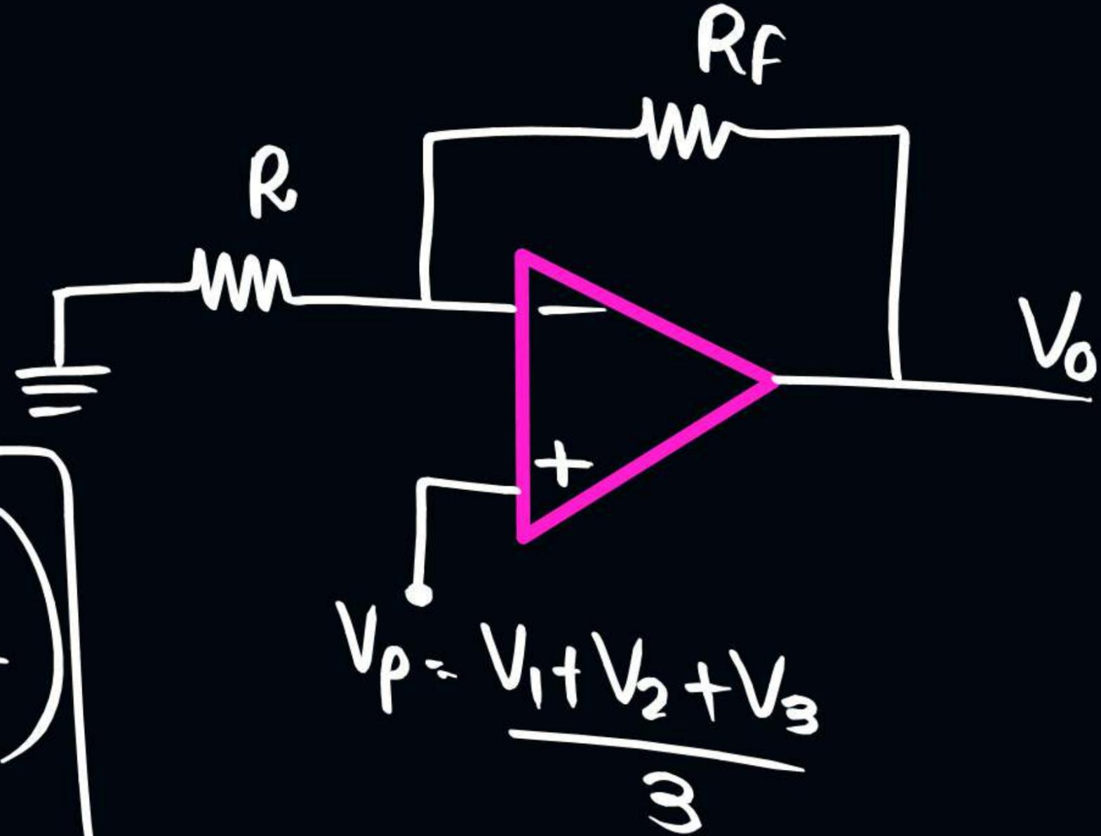
$$V_p = \frac{V_1 + V_2 + V_3}{3}$$
